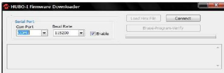
③ Exécuter le HUBO\_Firmware\_Loader.exe, sélectionner « COM Port » et cliquez sur « Connect. » La vitesse est de 115200 Bauds. Reportez-vous à la rubrique 9. Connexion à un PC pour vérifier le port COM.
