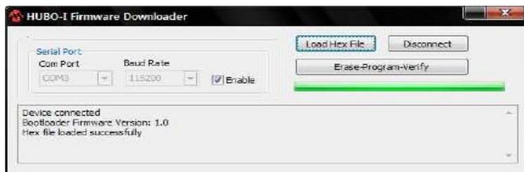
④ Cliquer sur « Load Hex File » et sélectionnez le logiciel interne (firmware) téléchargé. Si le gestionnaire de téléchargement lit avec succès le fichier du firmware, le message « Hex file loaded successfully » est affiché.
