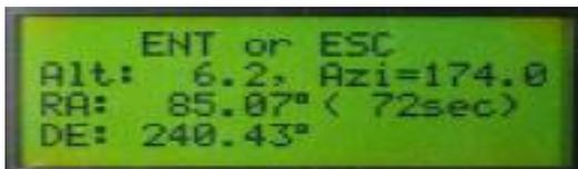
**2 ALGN** ⇒ Sélectionner « Guide Star » avec les touches fléchées ⇒ **ENT.** ⇒ Sélectionnez l'étoile d'alignement avec les touches fléchées ⇒ **ENT.** ⇒ **1 GOTO** ⇒ **ENT.** (terminé)
