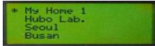
Appuyer et maintenir **ENT.** ⇒ Sélectionner « Location » avec les touches fléchées ⇒ **ENT.** ⇒ Choisir un site avec les touches fléchées ⇒ Appuyer et maintenir **ENT.** ⇒ Changer le nom avec les touches fléchées ⇒ **ENT.** (terminé)
