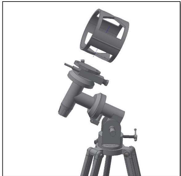
Fig. 5. Montaje y fijación de las arandelas.
