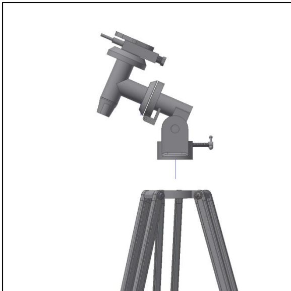
Fig. 4. Instalación de la montura ecuatorial.
